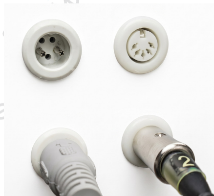
ABBILDUNG 14 Buchsen der Einheit und ihre Stecker: Jedes Kabel wird unter Beachtung der Nummerierung in seine Buchse gesteckt.
