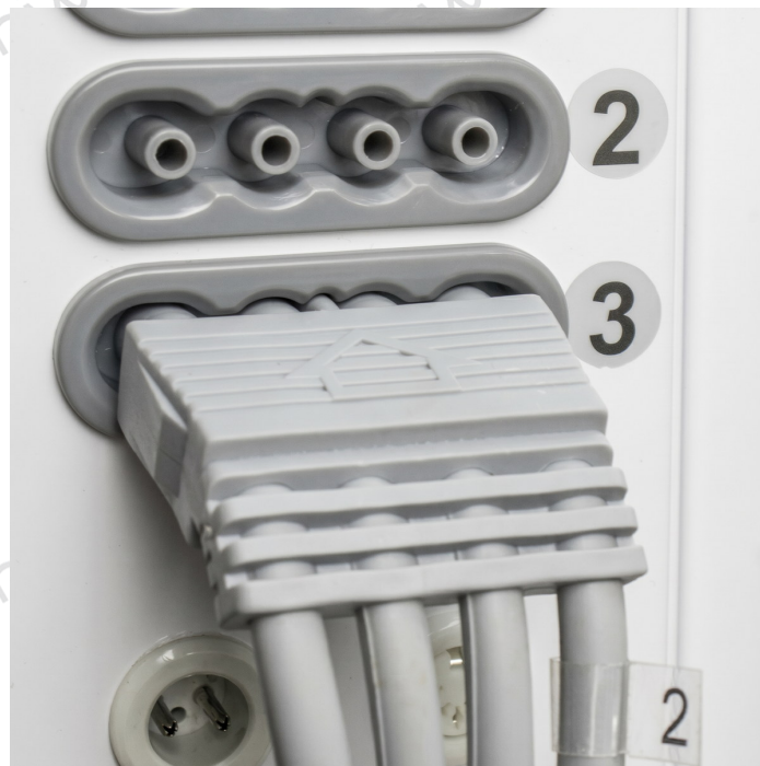
ABBILDUNG 03 Vordere Anschlüsse: Mehrfachstecker der Pressotherapie-Schläuche sowie Buchsen für Elektrostimulation und Infrarot.
