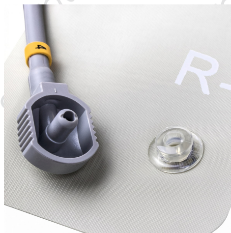
ABBILDUNG 12 Anschluss eines Schlauchs an seinen Stutzen: Die Nummer des Schlauchs muss mit der auf dem Modul markierten Kammer übereinstimmen, mit dem Präfix L oder R der Körperseite.
