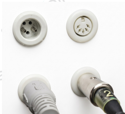
FIGURE 14 Prises de l'unité et leurs connecteurs : chaque câble s'insère dans sa prise en respectant la numérotation.
