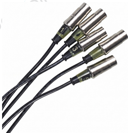
FIGURA 13 Cabos do circuito de infravermelhos, numerados de 1 a 5 consoante a zona de aquecimento.
