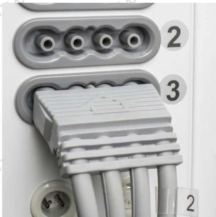
FIGURA 03 Ligações frontais: conectores múltiplos dos tubos de pressoterapia e tomadas de eletroestimulação e de infravermelhos.
