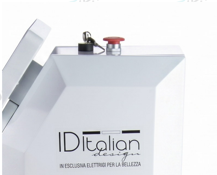
FIGURA 01 Parte superior da unidade: botão de paragem de emergência e fechadura contígua.
