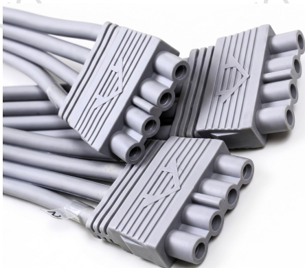
FIGURA 11 Conectores múltiples de los tubos de presoterapia: la flecha grabada debe quedar orientada hacia arriba.
