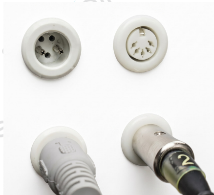
FIGURA 14 Tomas de la unidad y sus conectores: cada cable se inserta en su toma respetando la numeración.
