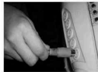
ABBILDUNG 15 Anschluss des Infrarot-Heizkreises.
