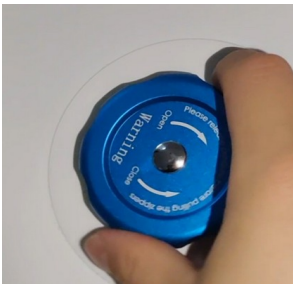
5. Apriete la válvula de alivio de presión en sentido horario para ajustar la presión dentro de la cámara
