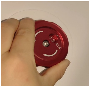
6. Ajuste la presión mediante la válvula manual de regulación de presión. Consulte el manual para más detalles.
